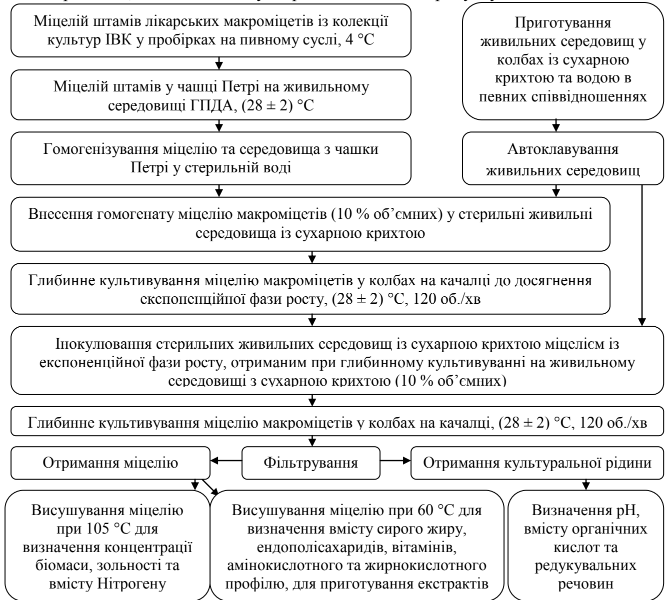
Рис. 6. Схема процесу глибинного культивування лікарських макроміцетів на живильному середовищі з сахарною крихтою
