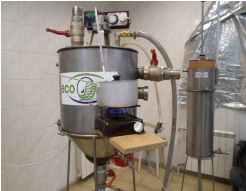
Рис. 2.6. Установа для отримання даних сумісної ферментації
