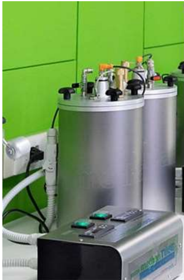
Рис. 2.5. Установка Methan Tube для оперативного визначення виходу біогазу із різних субстратів
