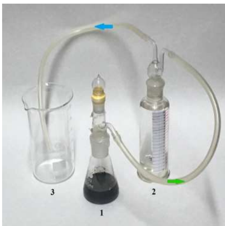
Рис. 4.1. Лабораторна установка для метанового ферментування багаси цукрового сорго з дигестатом I&U Group: 1 – колба з субстратом (біореактор метаноутворення); 2 – приймальна мірна ємність для біогазу (колба Дрекслея) з витісненням води; 3 – мірний стакан для витісненої води
