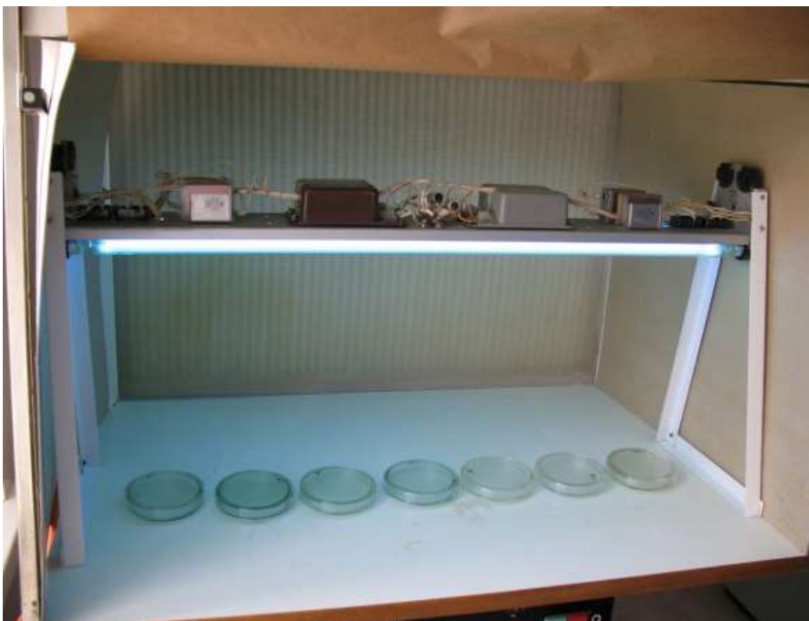
Рис. 2.3. Установка для опромінення бактеріальної культури УФ, \lambda=254 нм
