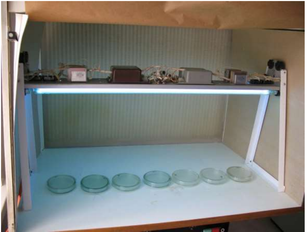
Рис. 2.3. Установка для опромінення бактеріальної культури УФ, \lambda=254 нм
