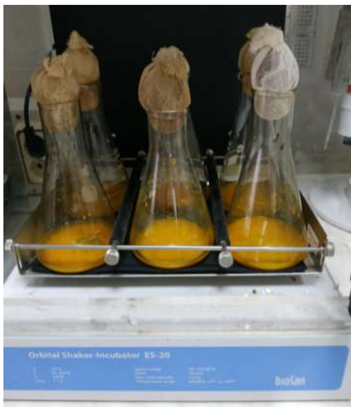
Рис. 7.1. Вирощування продуцента в маточних колбах на LB середовищі за температури 39°C на 62 годину культивування.
