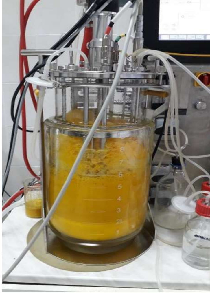
Рис. 7.3. Культуральна рідина штаму-продуценту B. subtilis IFBG МК-1А в біореакторі (на 48 годину культивування)
