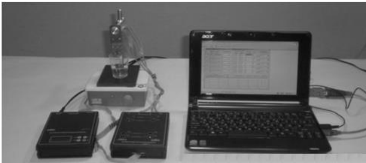
Рис. 2.11. Зовнішній вигляд робочої установки для проведення кондуктометричних вимірювань, до складу якої входить: кондуктометр, робоча комірка з перетворювачем і персональний комп'ютер.
